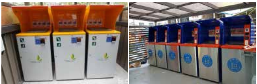
RFID 음식물류 폐기물 종량기 설치사례
